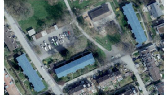
Vue aérienne du lotissement Schachen, architecture typique des années 1940, avec des constructions basses et peu denses à ossature bois et des murs coupe-feu maçonnés, 2021
